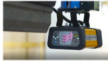
折弯机专用激光安全防护装置保护区域固定在刀尖下方并随着上方滑块同步运动，确保了折弯机高速下行时任何物体在接触刀尖前必先进入保护区域。一旦有遮挡物（如工人手指）进入保护区域，激光安全防护装置会立即发出信号并中断滑块的下行动作，从而保护操作工的人身安全。
