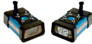
DSP 激光安全保护装置全面保护了折弯机操作工人安全，避免了由于机床上滑块的快速运动而产生的危险。针对折弯刀尖形成了一个块状的保护区域，保护刀尖的前、中、后区域。保护区域固定在刀尖下方并随着模具同步运动，确保了模具高速下行时下面的任何物体在接触刀尖前必先进入 DSP 产生的保护区域。一旦有遮挡物（如工人手指）进入 DSP 保护区域，DSP 会立即发出信号并中断滑块的下行动作。
