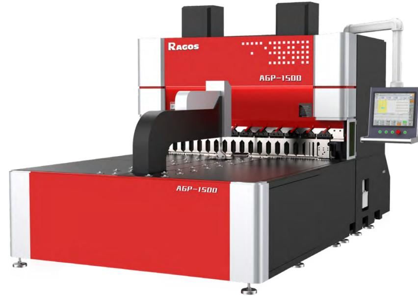
AG/AGP 系列是一款柔性智能折弯机，整体按照高精度机床标准进行设计和生产，采用高标号铸件，铸件、焊接件均进行了严格的消除内应力工艺处理，高精机床进行一体加工，确保整体机床长期运行精度、稳定性及高刚性。
