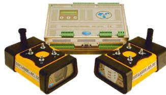
激光安全保护装置 DSP LASER AP-MCS 是目前世界上安全功能最齐全的一种折弯机安全防护装置。该装置是由一个发射端 TX、接收端 RX、安全控制模块 MCS 和测试工具构成。安全模块 MCS 可以接收来自通讯口的报警，监控和管理折弯机一些具有安全功能的组件运行情况，并负责发送给折弯机数控系统。
