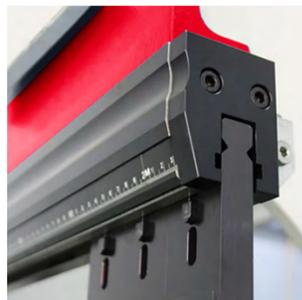
自动夹紧系统适用于频繁、快速换模的折弯机，尤其适用于小批量、多品种的钣金加工模式。基于“单点操作”的理念，自动夹紧系统只需通过一个按键即可实现模具夹紧、松开的过程，不仅保证了夹具的整体加工精度，而且提高了模具装夹的效率。
