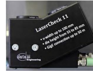
激光角度检测补偿系统采用激光光束对板材进行测量，通过计算激光光束与板材的交点坐标，实现对板材折弯角度的检测。激光检测技术具有高精度、高速度、非接触式等优点，可以有效提高折弯精度和生产效率。
