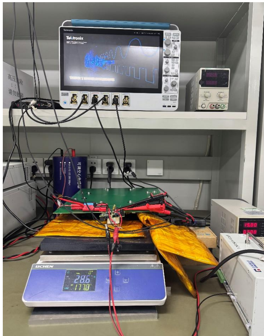
基于BTD5350SCWR搭建的双脉冲测试平台
